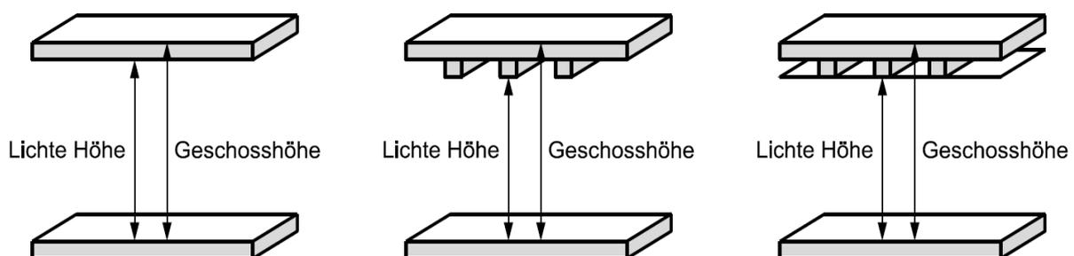
Die Geschosshöhe ist die Höhe von Oberkante bis Oberkante des fertigen Bodens.
